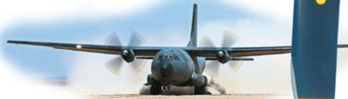
Deux turbopropulseurs Rolls-Royce (6000 CV chacun), hélices quadripales en composite fabriquées par Ratier-Figeac. Two Rolls-Royce turboprops (4550 kW each), composite four-bladed propellers made by Ratier-Figeac.
