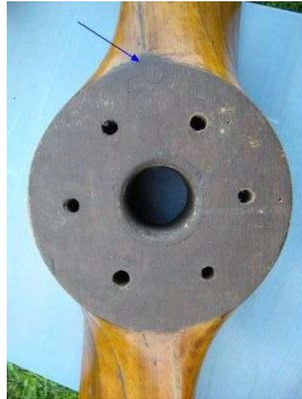
Hélice équilibrée au moyen d'un plomb dans le moyeu.
